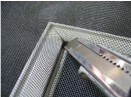
Wie beim Einrollen des Gummikeders wird in einer Ecke des Spannrahmens begonnen.
