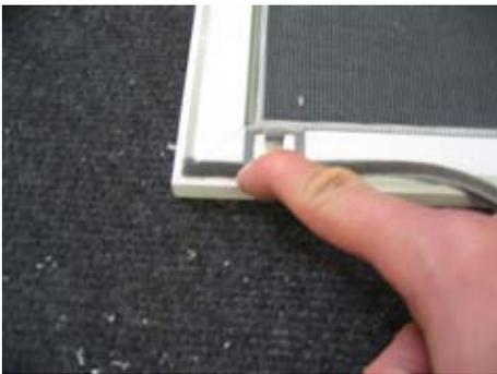
Die Bürstendichtung in einer Ecke ansetzen und mit dem Finger in den Bürstenkanal drücken.
