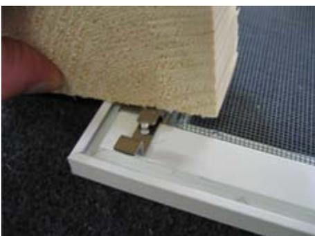
Clipsadapter auf das Profil einrasten lassen.
