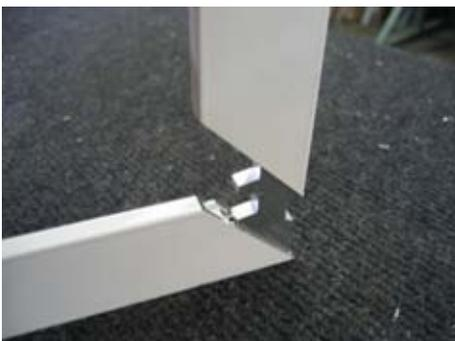
Jetzt die beiden verbleibenden Profile auf eines der bereits mit Eckverbindern ausgestatteten Profile schieben...
