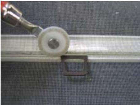
Kedergriff zwischen Gewebe und Gummikeder im Kederkanal platzieren und den Gummikeder wieder mit dem Einrollwerkzeug einrollen.
