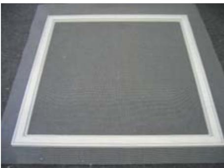
Spannrahmen mit der Innenseite nach oben (Kederkanal und Bürstenkanal sichtbar) auf den Montagetisch legen.
